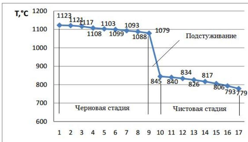
Рис. 2. График распределения температуры прокатки по проходам
