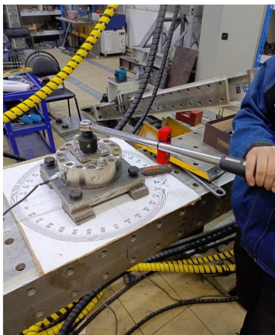
Рис. 3. Снятие показаний угла поворота ключа
