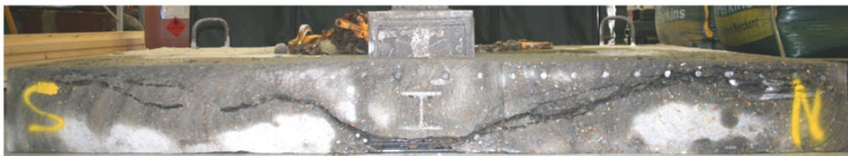
Рис. 18. Разрушение экспериментальной модели. Опыт без пластины и без поперечной арматуры (HS13-00) [9]
