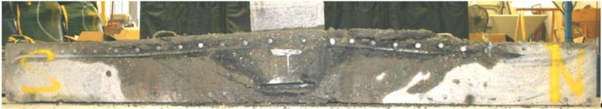
Рис. 10. Разрушение экспериментальной модели. Опыт с пластиной с поперечной арматурой (HS13-CT) [9]
