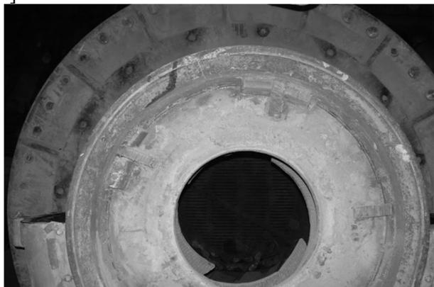
Рис. 2. Изношенная цапфа, подготовленная к ремонту
