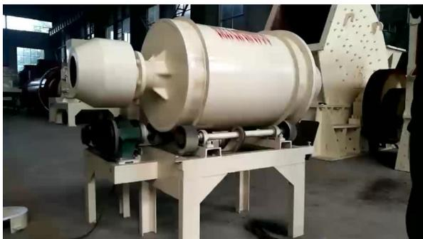
Рис. 1. Лабораторная роторно-шаровая мельница
