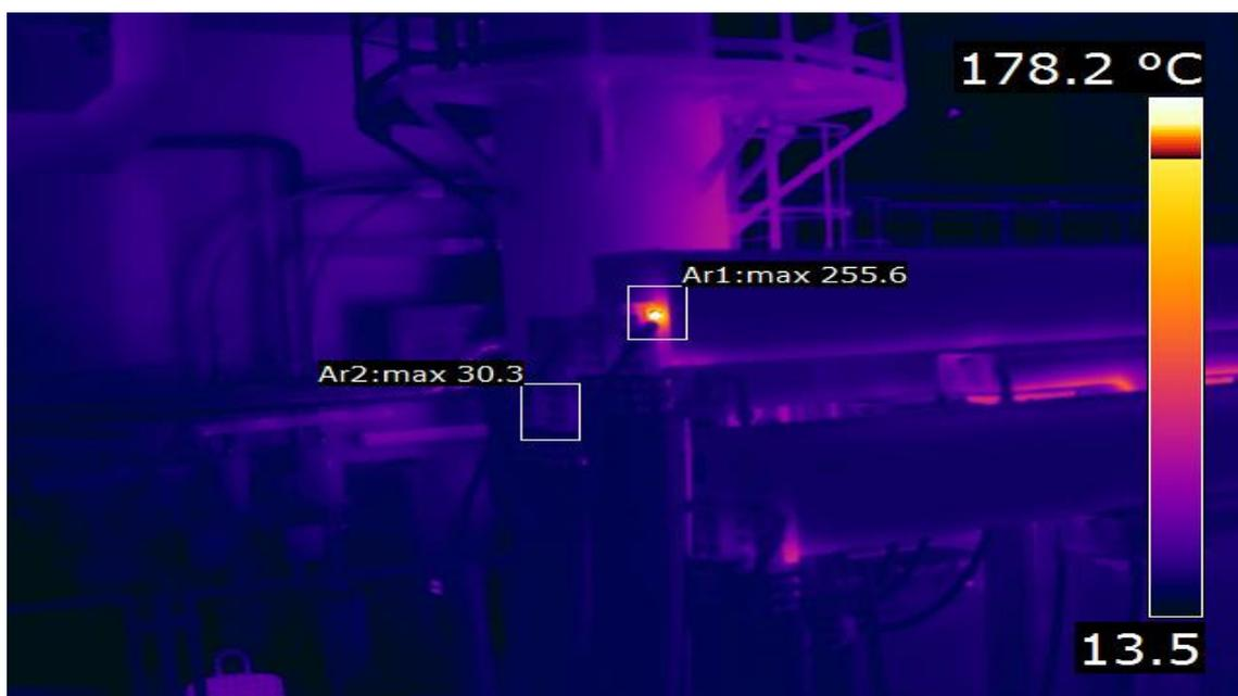
Рис. 1. Термограмма гибкого водоохлаждаемого токопровода 0,4 кВ
