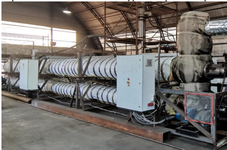
Рис. 7. Опытно-промышленная установка низкотемпературного термолiza, расположенная на ООО «ТК «Экотранс». Производительность Q – 500 кг/ч
