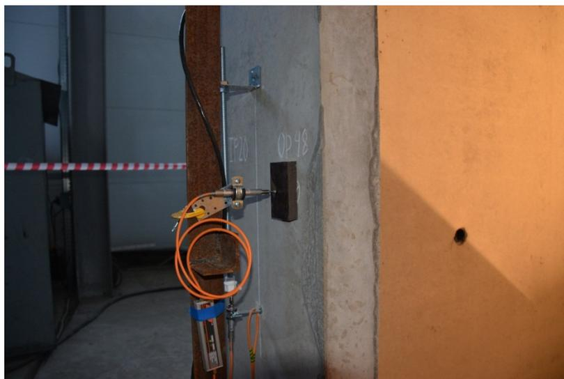
Рис. 9. Индукционные датчики из плоскости стен
